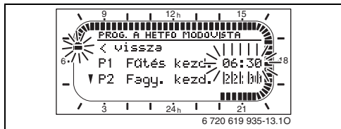
13 ábra A kapcsolási idő beállítása
